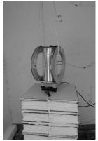
**Figure 7.** Vector/scalar Overhauser magnetometer POS-4. PET, Paratunka (Petropavlovsk).
